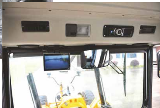
Радио, звуковое оборудование, камера заднего хода
